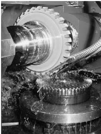
Usinagem CNC de uma engrenagem de ângulo reto PowerTRUE™
