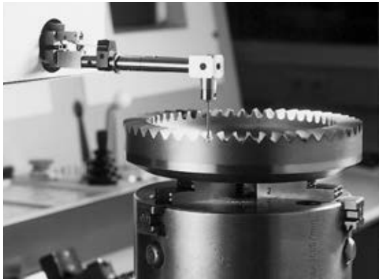
Mapeamento computadorizado do perfil dos dentes da engrenagem
