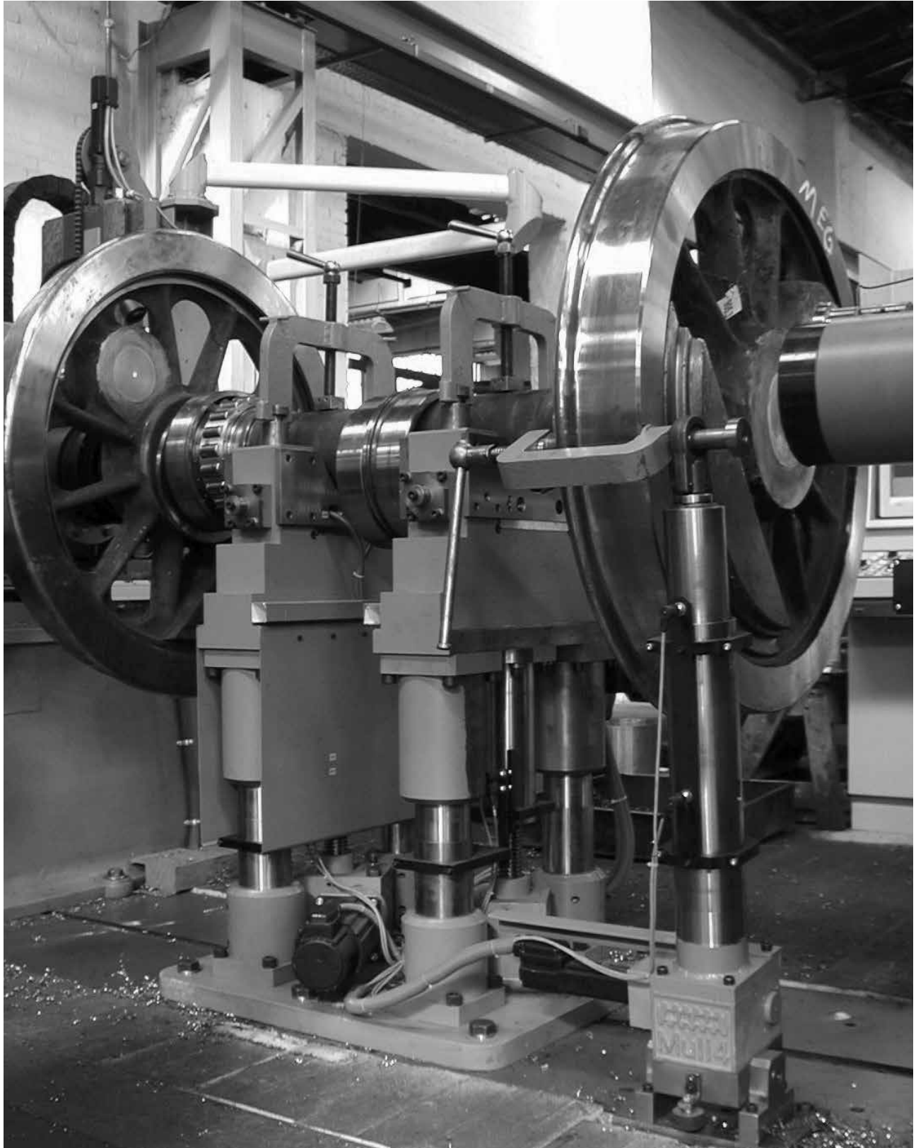
德国霍曼铁路技术公司，拉杆式机车测量轴
